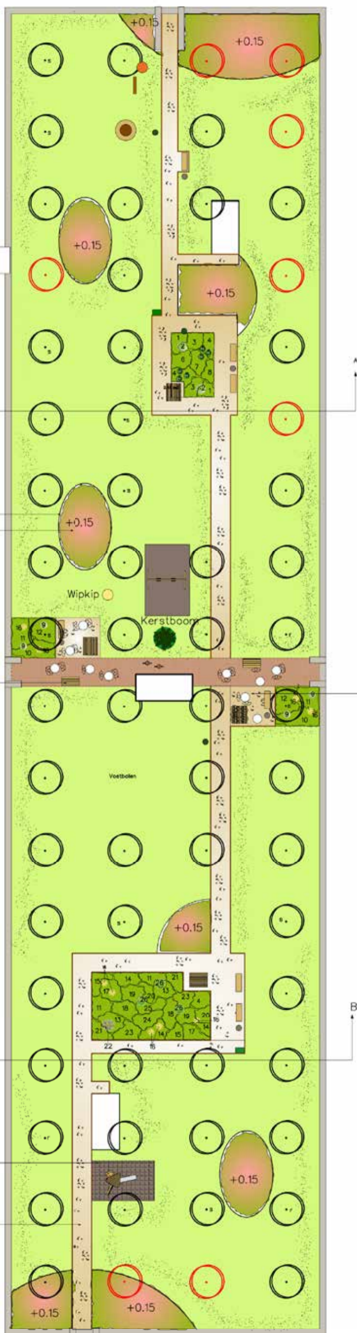
Padvast halfverharding laag van 12 cm op 5 cm zand op ca. 10 cm aanwezige schelpenpaden (Schelpenlaag was 20 cm, maar is ingeklonken)
